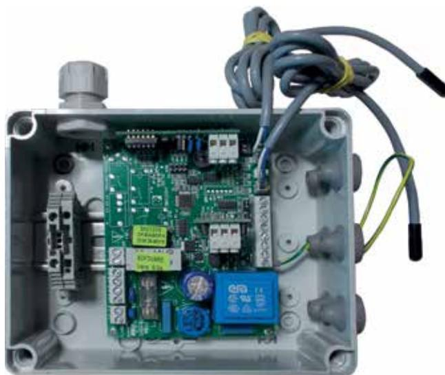
Attivando la funzionalità della sonda T3, di minima, è possibile arrestare il funzionamento del ventilatore in inverno quando la temperatura della batteria è inferiore a 32°C e l'avvio quando la temperatura raggiunge i 36°C. In funzionamento estivo il ventilatore si arresta quando la temperatura in batteria è superiore a 22°C e si avvia quando è inferiore a 18°C.
