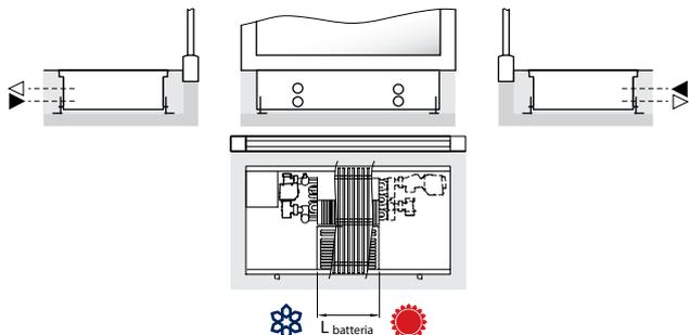
**A6** – Batteria calda: attacchi destri. Batteria fredda: attacchi sinistri.
