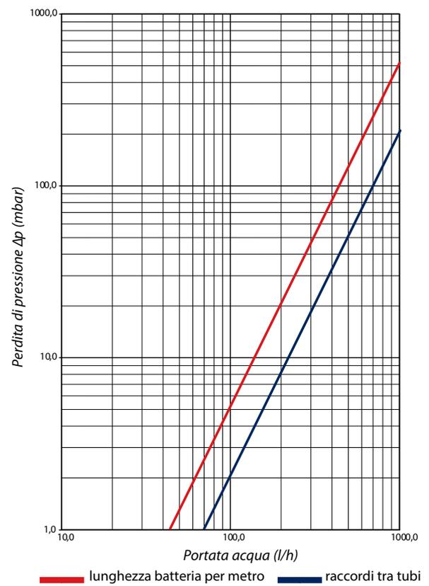
I **ventilconvettori Sabiana** possono essere equipaggiati con una valvola di regolazione ON-OFF o con una valvola di regolazione modulante che permette una taratura di precisione per piccole quantità d'acqua. I valori di impostazione relativi alla valvola modulante possono essere ricavati dal seguente grafico.
